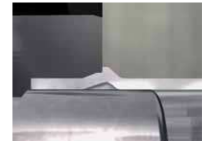
3. Die Kontur des Anschlusses wird durch die Geometrie der Werkzeuge bestimmt. Der Umformprozess ist abgeschlossen.
